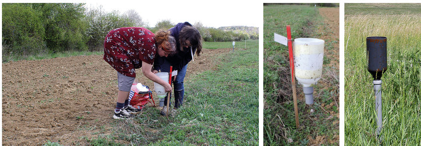
Obr. 19, 20, 21: Instalace jednoho z prvních typů lapačů na lokalitě Mašovice – u cesty (vlevo) a stejný lapač po měsíční expozici se zachycenými diasporami a bezobratlými živočichy na lepovém pásu na povrchu. Záchytový sáček z textilie se nachází uvnitř šedé trubky v ústí lapače. Vpravo jiné technické řešení s lapačem tmavé barvy, zašroubovaným přímo do perforované trubice.
